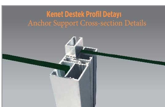
**Kenet Destek Profil Detayı**
