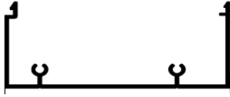
ÜST İÇ KAPAK UPPER INSIDE COVER Stok : 7 mt Ağırlık / Weight: 0,731 Kg/m
